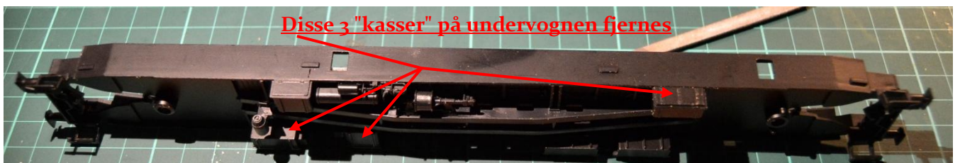
Køkkensiden af undervognen. De tre kasser, markeret med tre røde pile, sad ikke på 4071!
