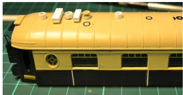
Ventil trængsel over køkkenet, 6 nye ventiler til at få røgen trukket ud af køkkenet.
